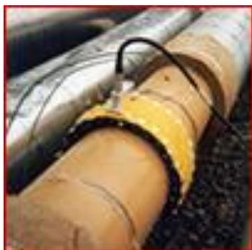
**Метод «Wavemaker»** - данная современная ультразвуковая система предназначена для оценки состояния трубопроводов и позволяет быстро обнаруживать коррозию и другие дефекты на наружных и внутренних поверхностях тепловых сетей (так называемая система скринингового тестирования труб).
