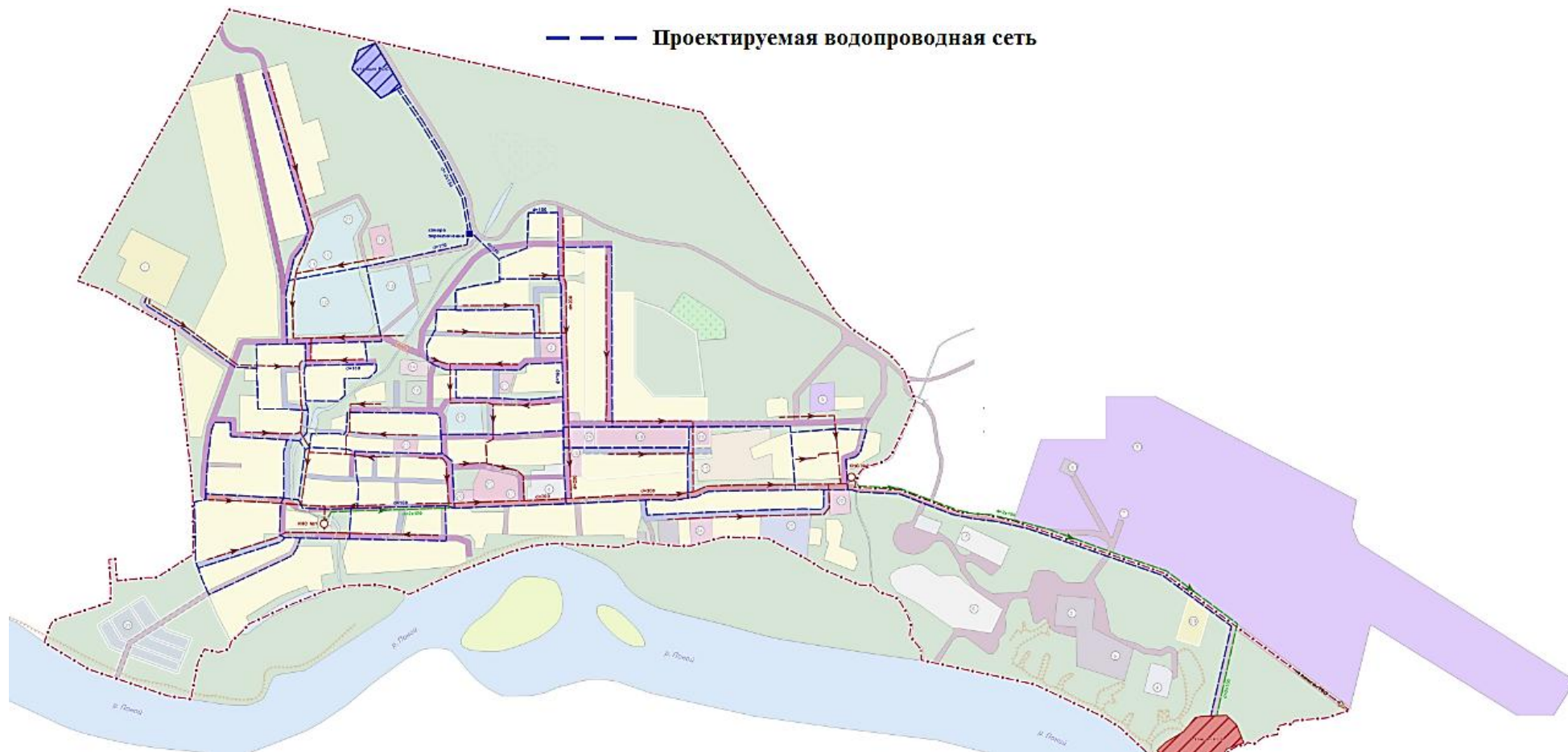
Рисунок 27 - Проектируемые водопроводные сети с. Краснощелье
