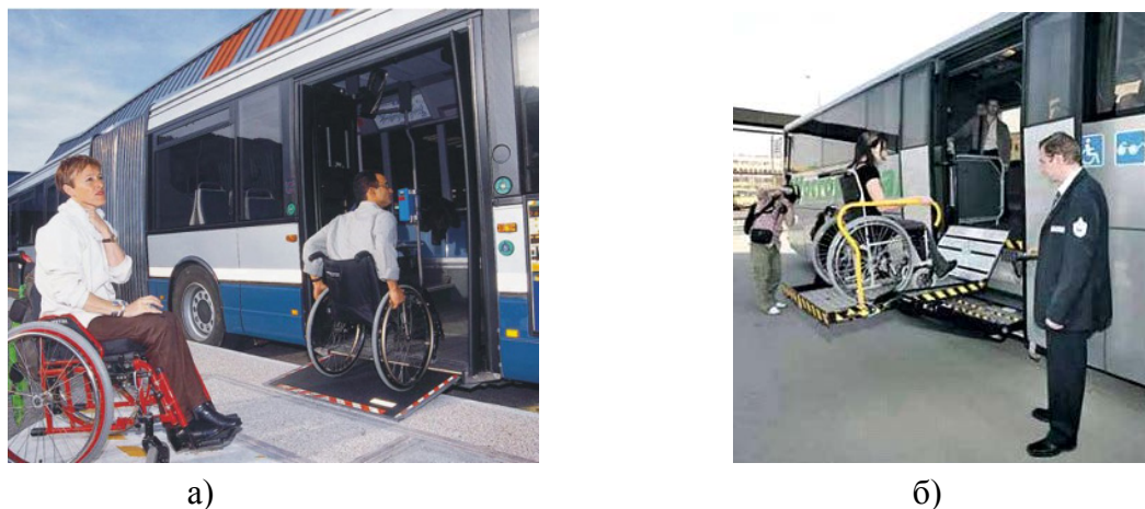
Рисунок 46– Примеры применения механической (а) и автоматической (б) аппарели автобуса на посадочной площадке в габаритах места посадки инвалидов
